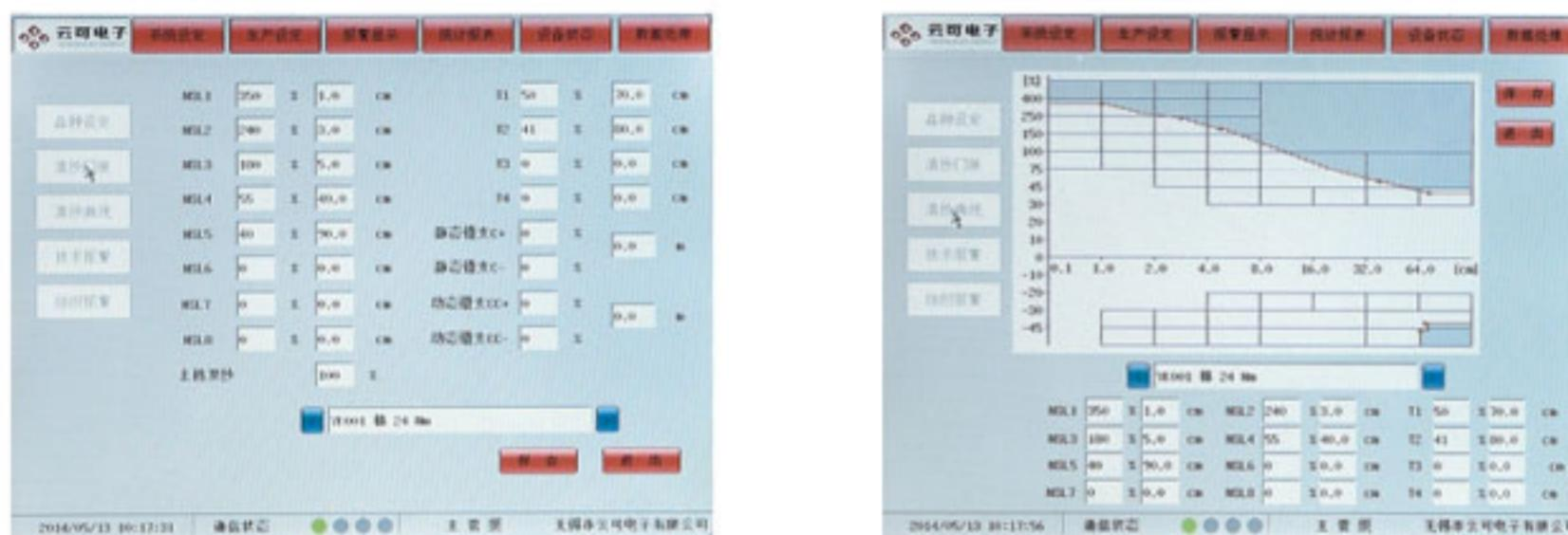
本设备采用“所设即所得”的可视化清纱设定，对相应的清纱通道参考点进行设定后，即形成相应的有害疵点的清除曲线，并进行清除。本设备可同时进行19个通道的设定，具体如下：
